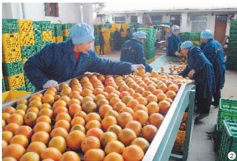
广西富川绿园果业有限公司是脐橙产销一体化的龙头企业，该公司脐橙种植面积达1050亩，以打造绿色产品为中心，在2007年获得了国家农业部的绿色食品认证。公司筹资购买了自动化果品处理设备，能自动清洗、消毒、按大小分类果实，并自动剔除有病虫害的果实，每一箱果大小、着色、重量几无差别，赢得顾客青睐。 图①：脐橙丰收了，周边的村民都来打短工，绿园公司每年能解决200多名农民就业。图为瑶族同胞在果园采摘脐橙。 图②：绿园公司自动化果品处理生产线。
